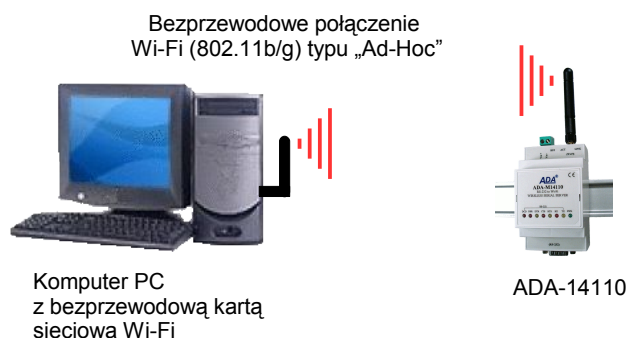
Rys 3. Podłączenie typu Ad-Hoc między serwerem portu ADA-14110 a komputerem PC
